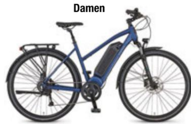
AEG EcoDrive-Mittelmotor mit Schiebehilfe und
