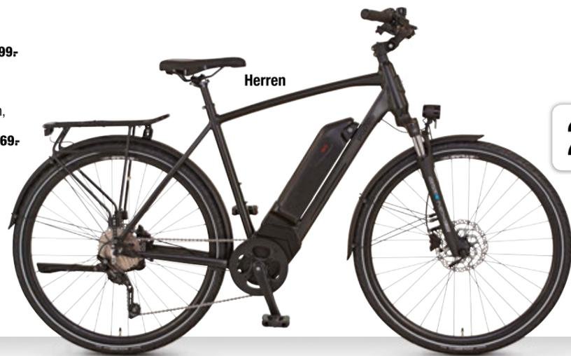
AEG ComfortDrive-Mittelmotor mit Schiebehilfe und 5 Unterstützungsstufen (250 Watt/100 Nm)
