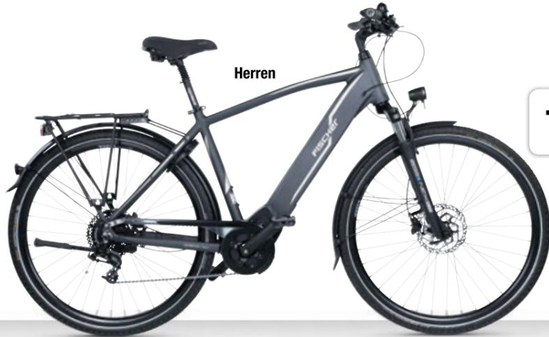
Brose Drive-C-Mittelmotor mit Schiebehilfe und 4 Unterstützungsstufen (250 Watt/50 Nm)
